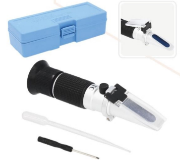
REFRAKТОМЕТР DO BADANIA ZAWARTOŚCI WODY/CUKRU W MIODZIE/SOKU/DRZEMIE
